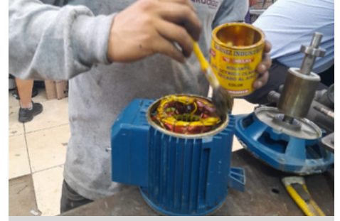
ARREGLO DE BOMBAS DE AGUA
